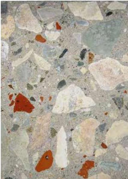
Schnitt durch einen R-Beton.
