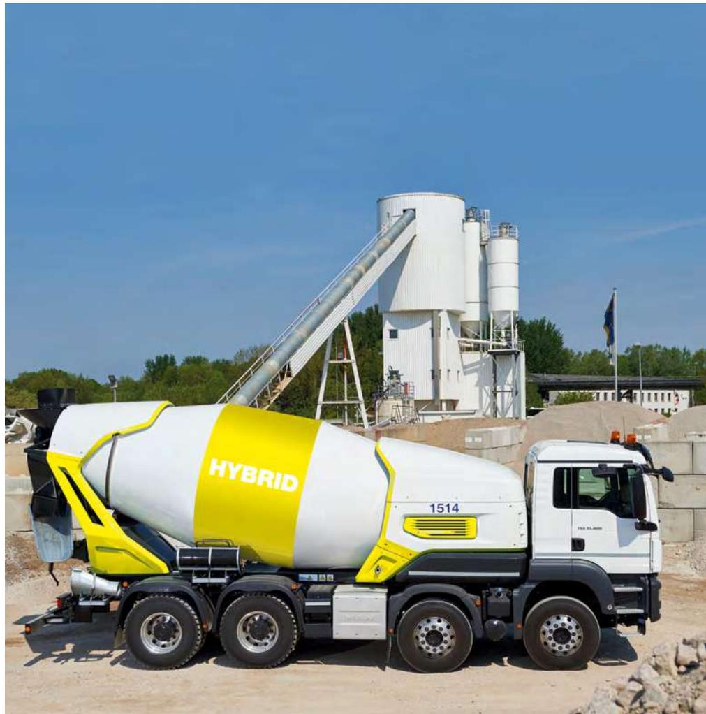
Bei diesem Hybrid-Transportbetonfahrmischer sorgt ein Elektromotor für den Antrieb der Mischertrommel. Die CO<sub>2</sub>-Emissionen sinken und die Lärmentwicklung ist geringer.
